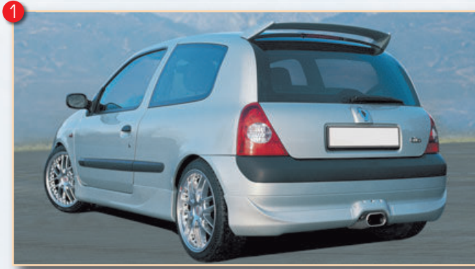
Spoileransatz Phase 1 mit verlängerter Stoßleiste und Nebelscheinwerfer
