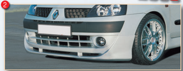
Spoileransatz Phase 1 mit verlängerter Stoßleiste und Nebelscheinwerfer
